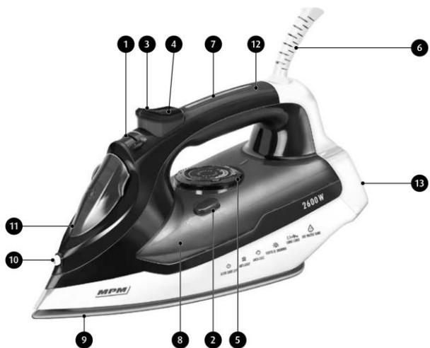
Ρυθμιστικό ελέγχου εξόδου ατμού, 0-35 g/min 2. Κουμπί ΑΥΤΟΚΑΘΑΡΙΣΜΟΥ (καθαρίζει το σίδερο από αλάτων) 3. Κουμπί Φεκασμού νερού 4. Κουμπί εκτόξευσης ατμού, μέγ. 80 g/min 5. Κουμπί ρύθμισης θερμοκρασίας 6. Καλώδιο ρεύματος με περιστρεφόμενο, μήκους 2,5 m 7. Ενδεικτική λυχνία κατάστασης λειτουργίας, ένδειξη ενεργοποίησης και αυτόματης απενεργοποίησης 8. Δεξαμενή νερού 430 ml 9. Κεραμική σόλα 10. Ακροφύσιο φεκασμού 11. Καπάκι πλήρωσης νερού 12. Λαβή 13. Πίσω σώμα/βάση με αντιολισθητική επίστρωση
